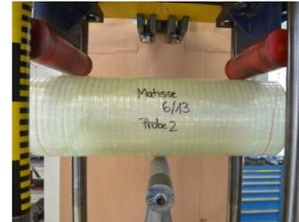
Fig. 7. 3PB test
